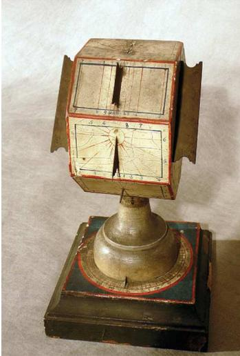
L'ensemble comporte un polyèdre à 10 faces monté sur un pied en bois tournant sur un socle à base carrée. Sur les 10 faces du polyèdre, 9 représentent des cadrans solaires, la 10<sup>ème</sup> servant de support.
